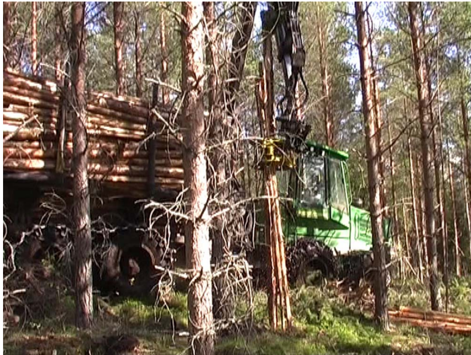
Figur 2. Bilden visar hur föraren jämndrar virket mot marken.
